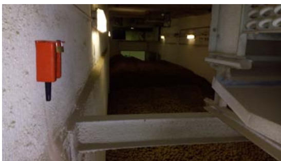
Obr. 1: Měření teploty a vlhkosti záznamovým měřícím zařízením ve skladovacím boxu
