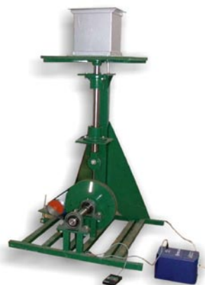
Obr. 1. Zkušební stolice (simulátor) pro testování mechanického zatížení vzorků brambor
